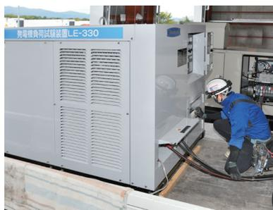
発電機負荷試験装置を自家発電設備に接続し、試験を実施
